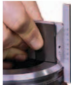
Calibro a tampone per il controllo di sedi per chiavette, centraggio e P/NP
