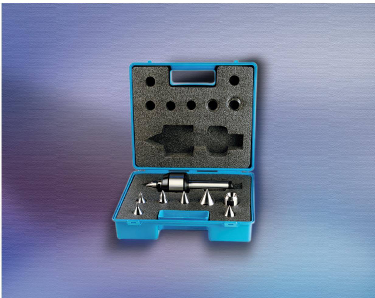
Si tratta di un assortimento di pezzi intercambiabili per contropunta tipo CN/R e CSF/R. Sistamate in un'elegante e robusta cassetta in plastica con imbottitura antiurto (in omaggio). Sono indicate per attrezzare macchine utensili e per le lavorazioni quotidiane di tornitura o rettifica.
